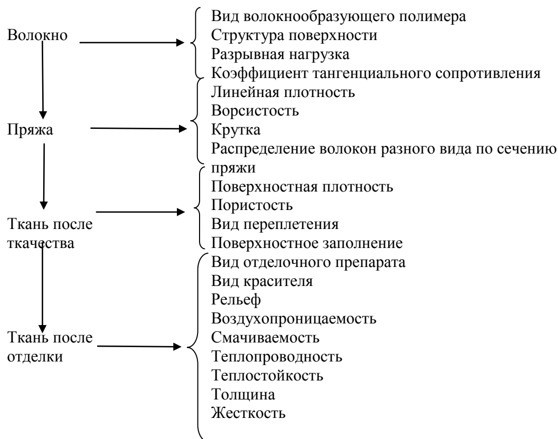
Рисунок 1.8 – Характеристики волокон, пряжи и ткани, влияющие на их взаимодействие со связующим
