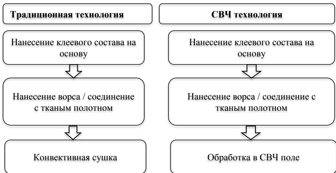
Рисунок 7.14 – Схема технологии формирования слоистых материалов
