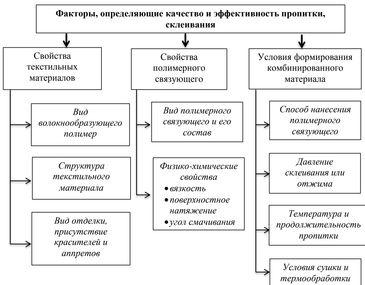
Рисунок 2.4 – Классификация факторов, влияющих на формирование комбинированных текстильных материалов
